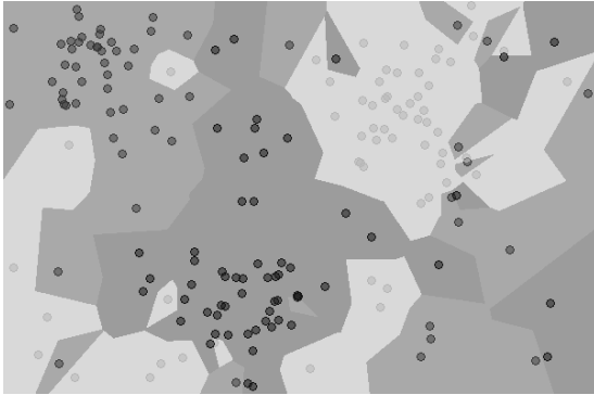
Hình 9.1. Ví dụ về 1NN. Các hình tròn là các điểm dữ liệu huấn luyện. Các hình khác màu thể hiện các lớp khác nhau. Các vùng nền thể hiện các điểm được phân loại vào lớp có màu tương ứng khi sử dụng 1NN (Nguồn: K-nearest neighbors algorithm – Wikipedia, xem ảnh màu trong Hình B.1).
