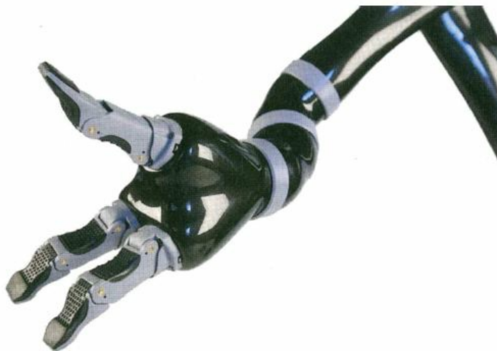
Hình 16.1: Jaco, cánh tay robot trợ giúp cho những người khuyết tật của Kinova
