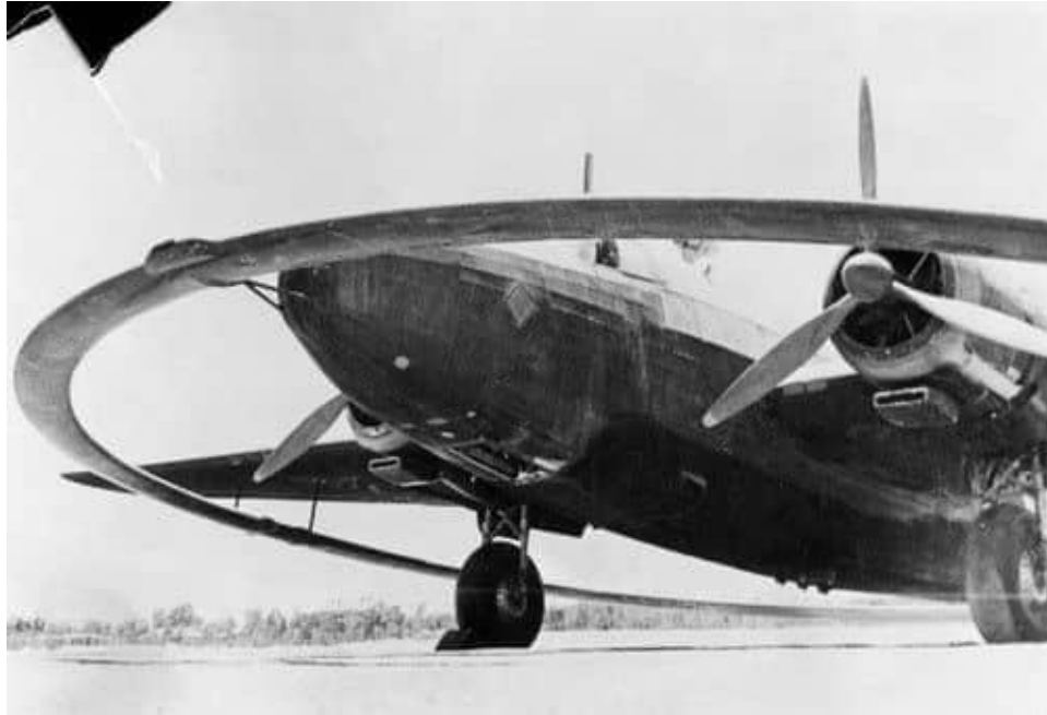
Một chiếc Vickers Wellington DWI (Directional Wireless Installation) trên mặt đất tại Ismailia, Ai Cập, cho thấy vòng điện từ được dùng để kích nổ các bãi mìn từ tính. Ảnh chụp quãng 1940-1943.
