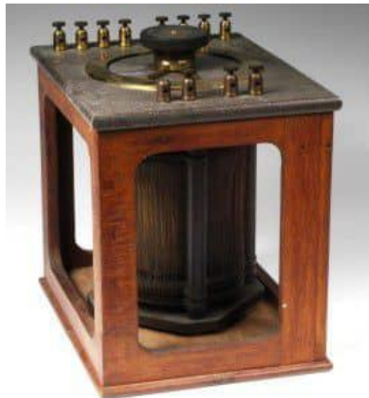
Ăng-ten và máy tầm phương Bellini-Tosi-Marconi, sản xuất bởi công ty điện báo viễn thông Marconi năm 1916
